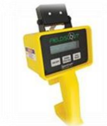
Figura 10. Medidor de índice se clorofila “a” FieldScout CM1000.
